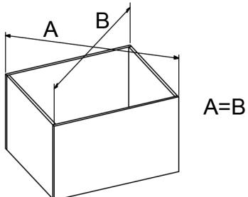
Die letzte Etappe ist das Möbels an der richtigen Stelle zu positionieren, die Lot- und Sektrechte des Möbels mit einer Wasserwaage zu prüfen und die Scharniere zu regulieren.
