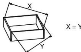
**Bitte beachten! Den Boden der Schublade wird festgenagelt, nach der Bestimmung der Diagonal zwischen den Elementen (siehe Abbildung).**
