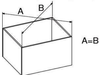
Die letzte Etappe ist das Möbel an der richtigen Stelle zu positionieren, die Lot- und Sektrechte des Möbels mit einer Wasserwaage zu prüfen und die Scharniere zu regulieren.
