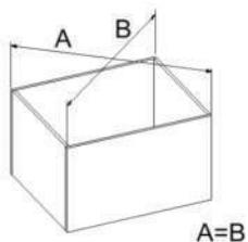
Posledným krokom je umiestnenie nábytku na správne miesto a pomocou vodováhy skontrolovaní vertikálnej a horizontálnej polohy nábytku a nastavenie čelných plôch na pántoch.
