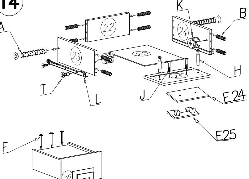
**PL UWAGA** Kołki nabijać w zaznaczone strzałkami miejsca. Długość wystającego kołka po wbiciu w otwór nie może przekraczać 9–10mm.
