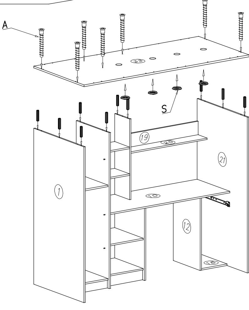
**PL UWAGA** Kołki nabijać w zaznaczone strzałkami miejsca. Długość wystającego kołka po wbiciu w otwór nie może przekraczać 9–10mm.
