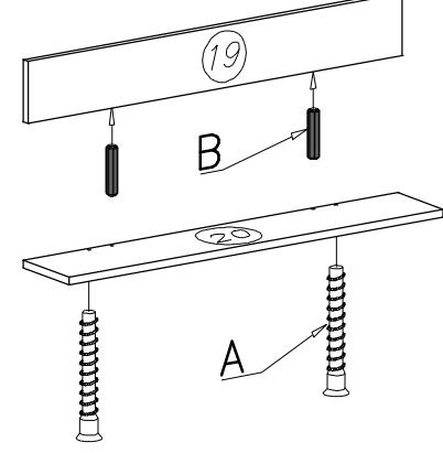
**PL UWAGA** Kołki nabijać w zaznaczone strzałkami miejsca. Długość wystającego kołka po wbiciu w otwór nie może przekraczać 9–10mm.
